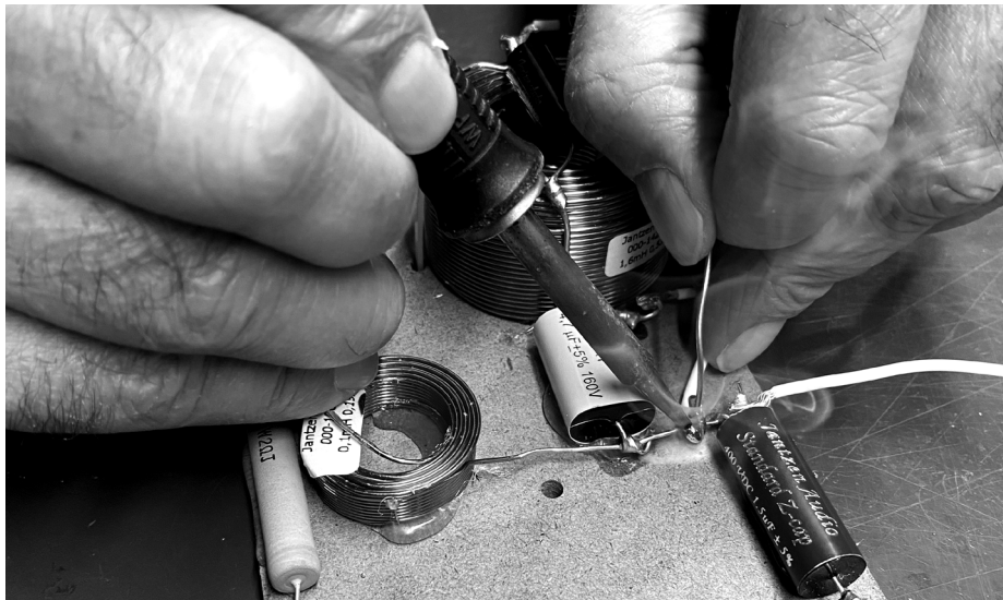
Photos de la fabrication du filtre répartiteur câblé en l'air, dans notre usine française à St-Fargeau (89).
